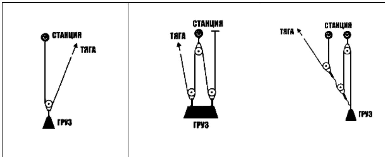
На грузовом канате выше тягового зажима должен быть установлен зажим для ограничения обратного хода конца каната, на котором закреплен груз. В плане производства работ с учетом оценки рисков может быть разрешено использование вместо зажима самозатягивающегося узла.
